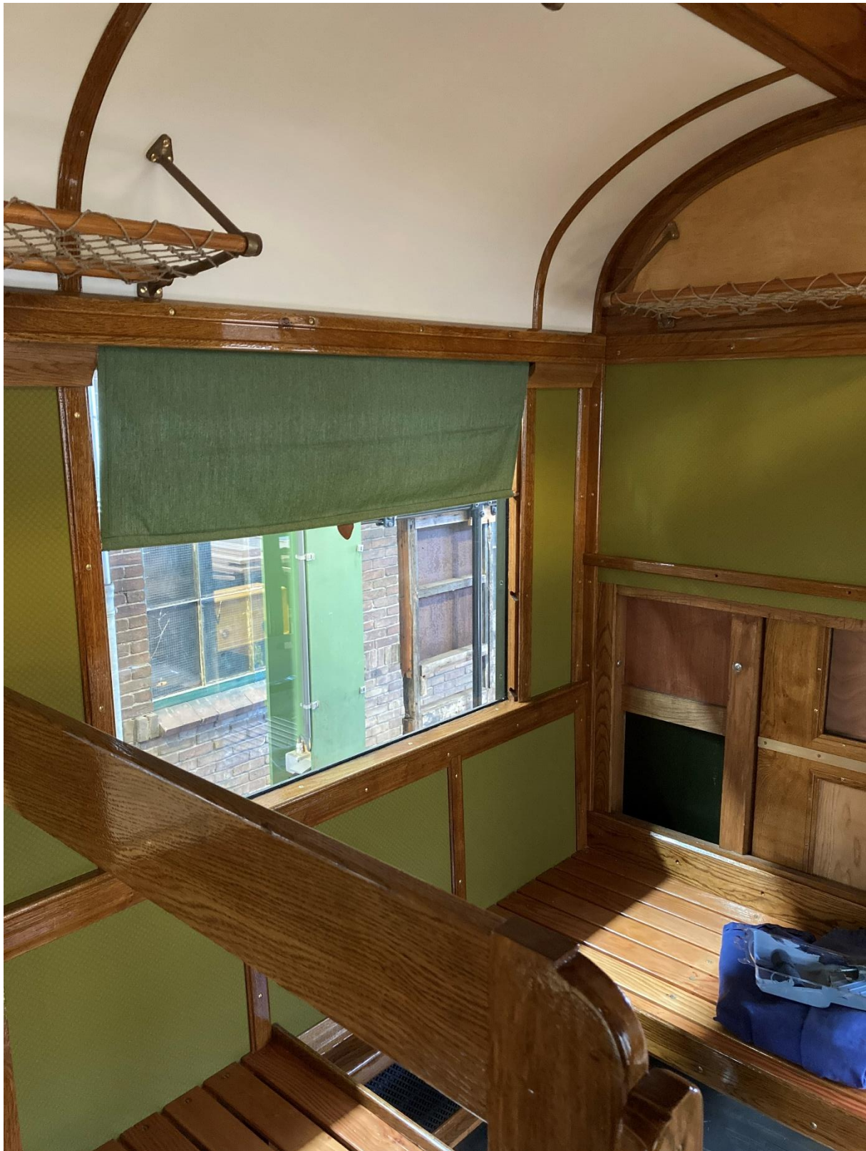
Het interieur van rijtuig 423 is nagenoeg gereed; ook de rolgordijnen voor de ramen zijn aangebracht.
