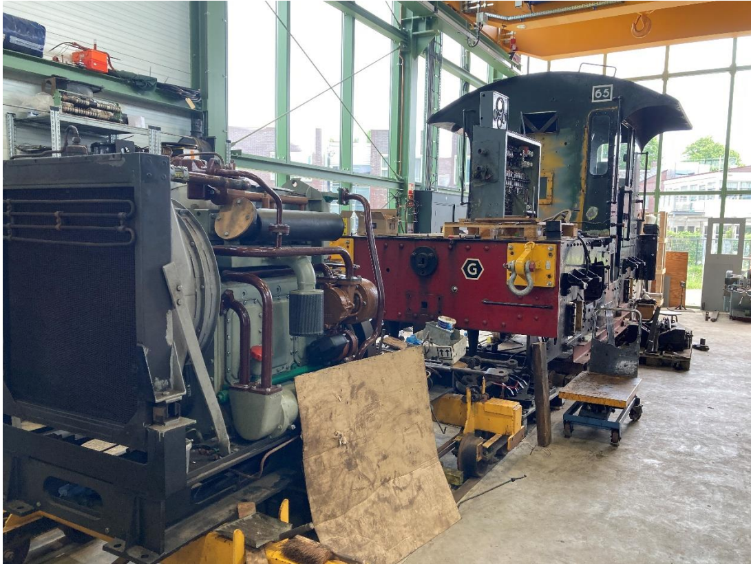
20 mei 2024: weer een rondje werkplaats met als resultaat locomotor 271 en de in te bouwen ruilmotor
