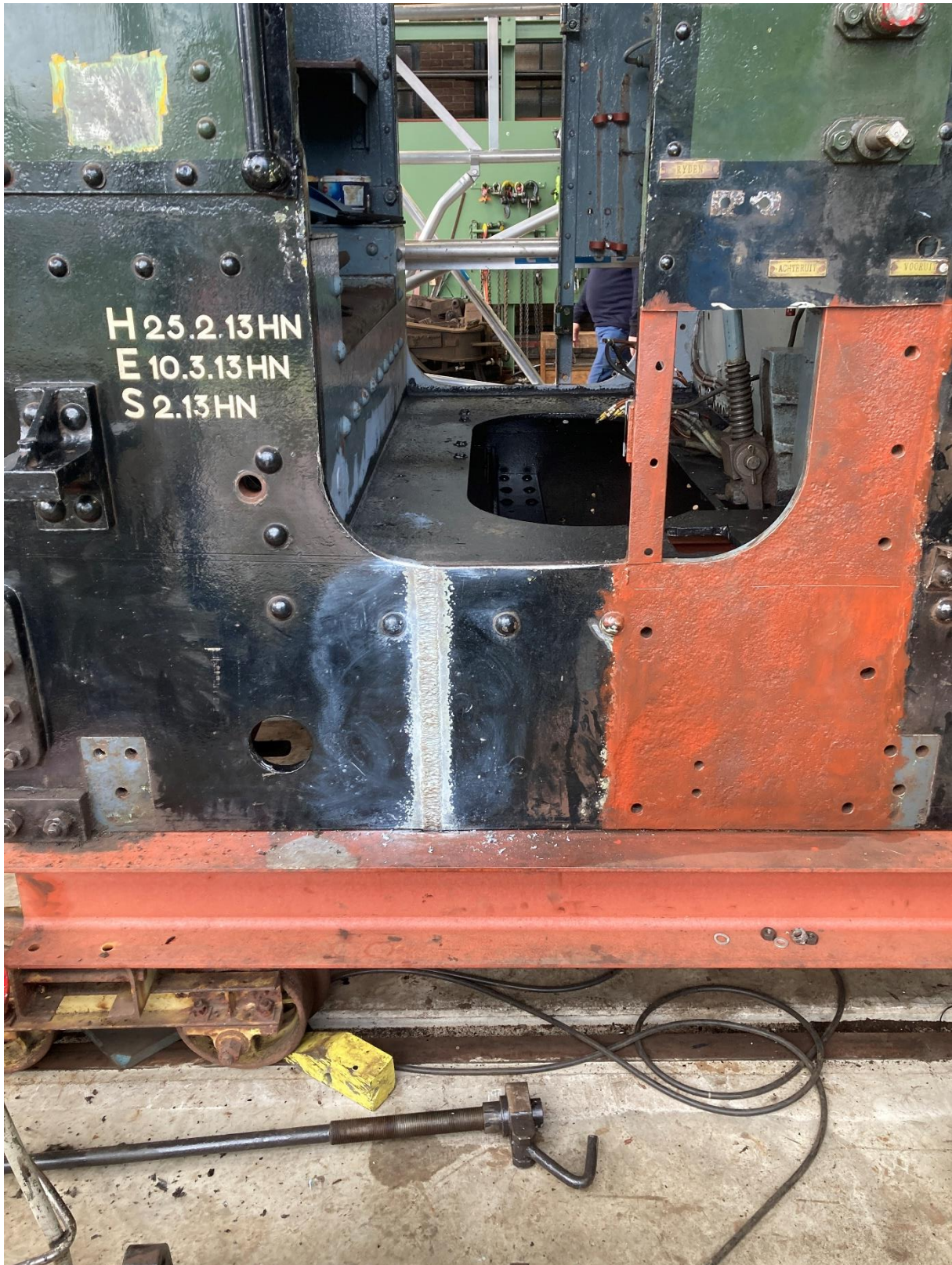
Na in het verleden bij NS opgelopen aanrijdingsschade was het frame van loc 271 gelast, maar altijd ietwat krom gebleven. Ook dat is nu aangepakt; aan het hulframe te zien is de loc nu weer recht.
